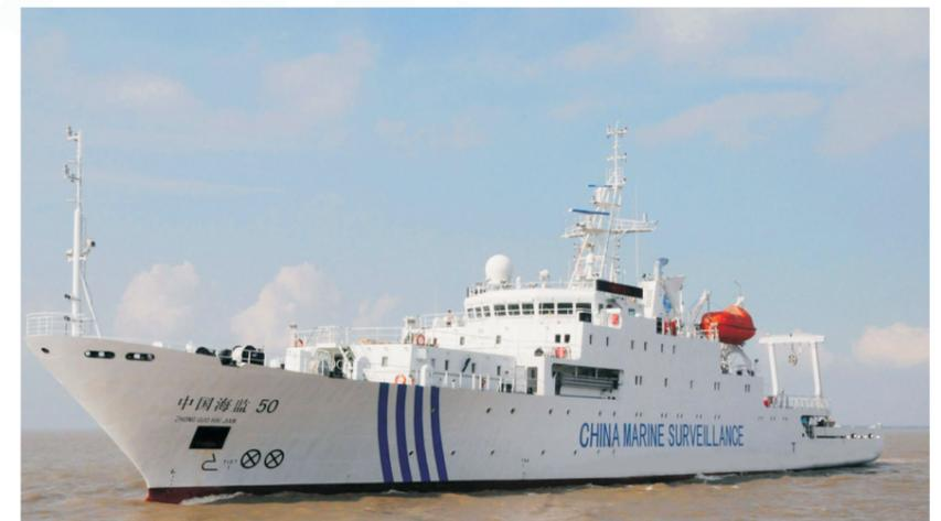
该船建造采用三维设计与模块建造技术，实现了海监船建造过程中的壳、舾、涂一体化；研发了吊舱基座内场制造、内场预安装与船台复杂曲面安装定位相结合的吊舱式推进器高精度安装新技术，解决了吊舱基座船台安装周期长的难点问题；开发了曲面舷门分段整体建造及总段安装技术，提高了舷门的安装精度和质量，确保了舷门的密封性能。通过各项工艺创新，提高了建造质量，缩短了船舶总体建造周期，节约了建造费用。该船的成功建造，为我国的海洋权益维护提供了强大的执法装备，在日益严峻的海洋局势中发挥出重大的作用。
