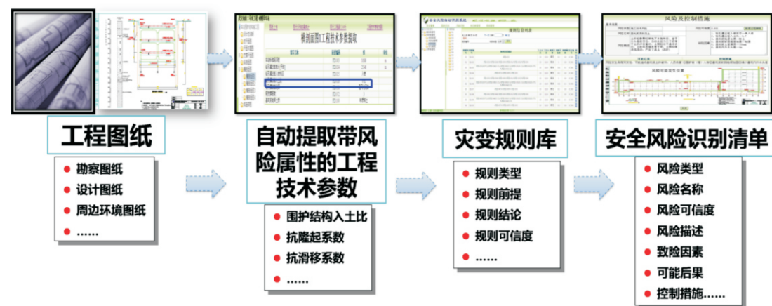
地铁施工安全风险自动识别系统
