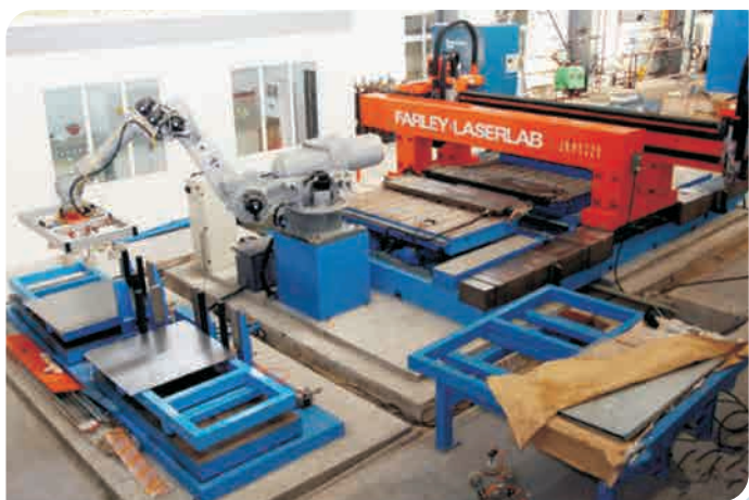
“汽车制造中的高质高效激光焊接、切割关键工艺及成套装备”拼焊机组
